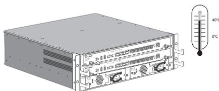
为保证路由器长期稳定工作, 延长使用寿命, 请维持环境一定的温度和湿度。过高或过低的环境湿度易引起绝缘材料漏电、变形甚至金属部件锈蚀现象, 温度过高会加速绝缘材料的老化过程, 严重影响设备使用寿命。该系列路由器的正常工作和存储温度/湿度如下表2-1。
