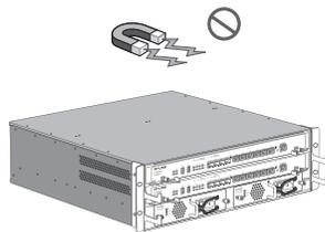
电磁干扰会以电容耦合、电感耦合、阻抗耦合等传导方式对设备内部的电容、电感等电子元器件造成影响,为减少电磁干扰因素造成的不利影响,请注意以下事项:
