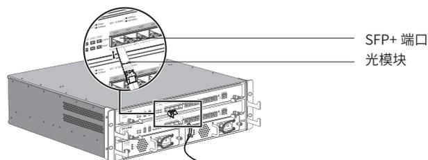
图3-3 SFP+端口连接示意图
