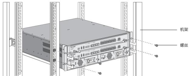
图2-3 机架安装示意图
