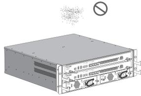
灰尘落在路由器表面会造成静电吸附,使金属接点接触不良。虽然设备本身在防静电方面做了一定措施,但当静电超过一定强度时,仍会对内部电路板上的电子元器件造成致命的破坏,为避免静电影响设备正常工作,请注意以下事项:
